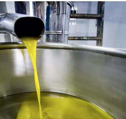
Das Öl muss aus der Frucht. Bei der Kaltextraktion wird Olivenöl nicht gepresst. Zentrifugen gewinnen es aus vorher zermahlenden Oliven.
